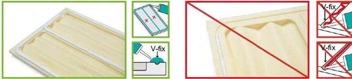
**ПРИМЕЧАНИЕ:** При установке двухсторонних панелей WX204-2600 RIPPLE и WX205-2600 TRACK высотой 2,60 м убедитесь, что наносите клей FDP700 на нужную сторону:
